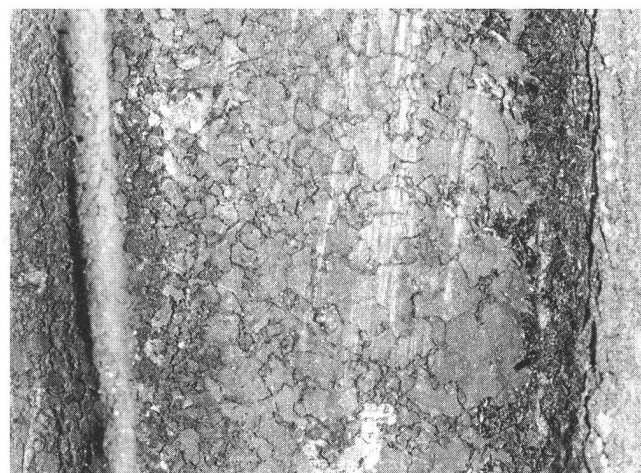
Fig. 14 Auf den mit stark basischen Lösungen bespülten Flächen liegen keine Korrosionsprodukte, sie sind vielmehr stark angeätzt — On n'aperçoit ici aucun produit de corrosion, mais une attaque profonde sur les surfaces traitées par les solutions fortement basiques Dadurch sind die Korngrenzen deutlich sichtbar, wie dieser vergrösserte Ausschnitt der bei pH 13,1 behandelten Probe zeigt (Vergrösserung 5,1fach) — On voit nettement apparaître la granularité du métal sur cet échantillon agrandi, sur lequel une solution ayant un pH de 13,1 a ruisselé (agrandissement 5,1 fois)
