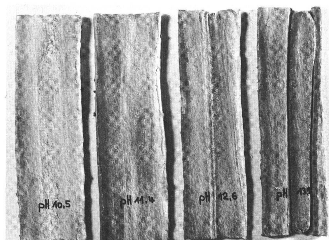
Fig. 12 Zustand der Blechproben aus Reinblei nach dem Versuchsabbruch — Etat des échantillons de plomb pur à l'achèvement des essais Die Proben lagen während 120 Tagen in Rinnsalen von Calciumlösungen der pH-Werte 10,5, 11,4, 12,6 und 13,1. Die beiden stark basischen Lösungen haben tiefe Gräben in die Bleioberfläche eingefressen, während die beiden in den schwächerbasischen Lösungen gelegenen Proben nur oberflächlich korrodiert sind (halbe natürliche Grösse) — Ces échantillons ont été exposés pendant 120 jours au ruissellement de solutions de calcium ayant les pH suivants: 10,5, 11,4, 12,6 et 13,1. Les deux solutions les plus fortement basiques ont rongé des sillons profonds dans le plomb tandis que les deux autres solutions moins concentrées n'ont corrodé les échantillons qu'en surface (1/2 grandeur naturelle)
