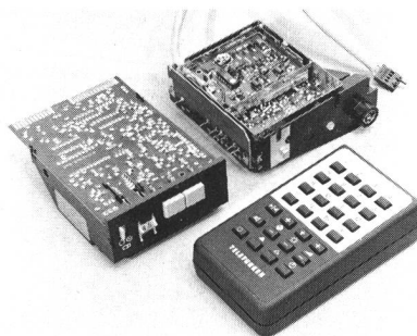
Fig. 11 Digitaler Programmspeicher (DPS) mit Phase-locked-loop-Tuner und Fernbedienungseinheit
