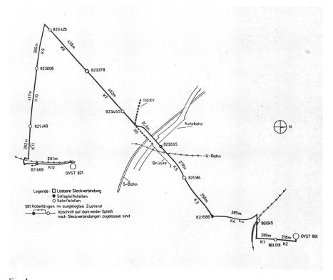
Streckenplan der Lichtleiter-Versuchsanlage der Deutschen Bundespost in Berlin. Auf demselben Trassee wurden Glasfaserkabel von vier deutschen Herstellern verlegt
