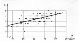
Fig. 12 Qualité de l'image de télévision en fonction du niveau HF Q<sub>1</sub> Note de qualité (télévision)
