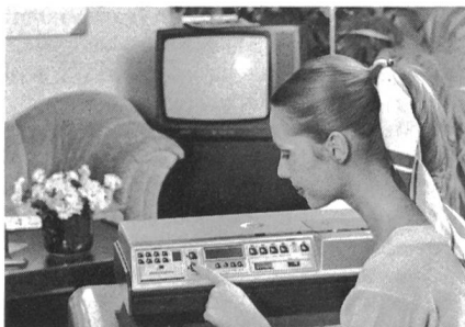
Fig. 7 Videorecorder für maximal 5 Stunden Aufnahme/Wiedergabe
