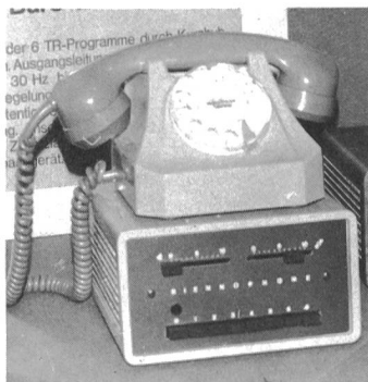
Fig. 5 Eine Neuentwicklung der Velectra AG, Biel, ist der Telefonrundsprachempfänger als Untersatz zum Telefonapparat, der vor allem für die Verwendung in Büros gedacht ist
