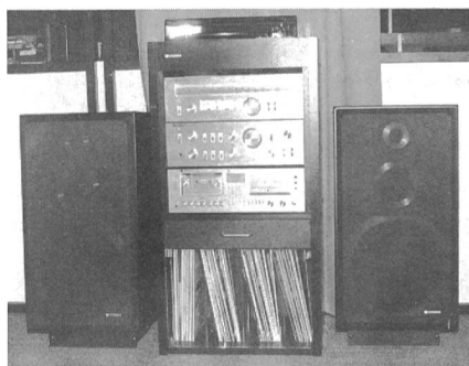
Fig. 3 HiFi-Geräteturm (Rack) mit (von oben nach unten) Plattenspieler, Tuner, Verstärker und Kassettenfrontlader sowie Raum für Schallplatten
