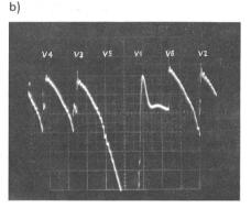
Fig. 2 Oszillografenbilder. Messung am 12,5-kV-Ausgang des Gleichrichters direkt vor den Siebgliedern, Einstellung des Oszillografen: 2 kV/Teilung, 2 ms/Teilung
