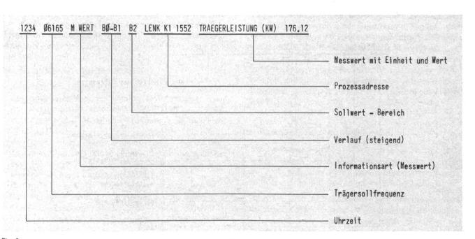
Datensatz eines Messwertes. Bei Sendebetrieb mit 250 kW Trägerleistung ist der Bereich B 2 der Sollwertbereich, wobei der Datensatz beim Überschreiten der Grenzen ausgedruckt wird
