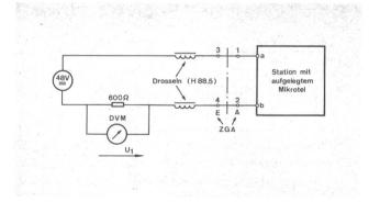
Prüfschaltung für den Abschaltestrom; die Spannung wird vom Digitalvoltmeter kontrolliert
