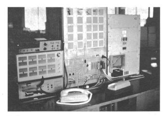
Fig. 12 Hotelstation mit Prüfadapter
