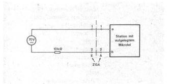
Fig. 7 Prüfschaltung für den Wecker
