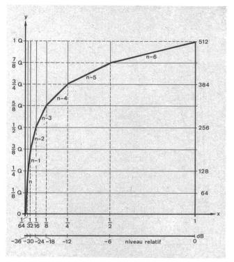
Fig. 1 Caractéristique de compression-extension à 13 segments
