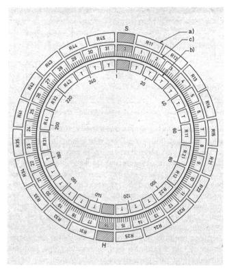
Fig. 5 Répartition des intervalles de temps dans la trame à 256 bit d'un conduit numérique à 2048 kbit/s
