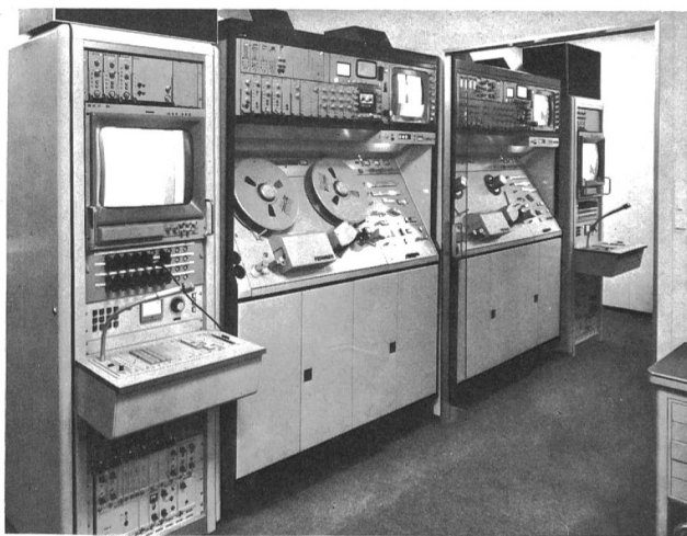
Fig. 14 Magnétoscopes pour la télévision en couleur du centre d'enregistrement (studio de Genève) — Magnetband-Aufzeichnungsgeräte für Farbfernsehen im MAZ-Zentrum des Studios Genf
