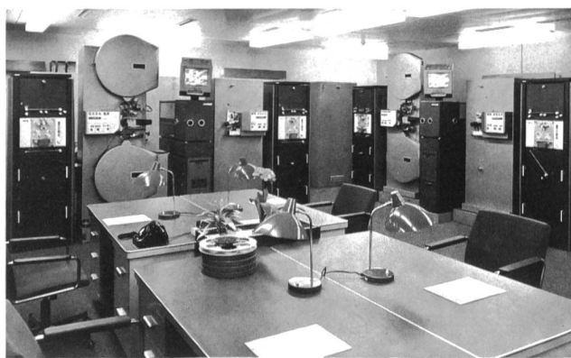
Fig. 13 Télécinémas à caméra ayant chacun un projecteur film 35 mm et un projecteur 16 mm (continuité 1 de Genève) — Filmabtaster mit Farbkamera, je mit einem Projektor für 35-mm und 16-mm-Film bestückt (Ablaufregie 1, Genf)
