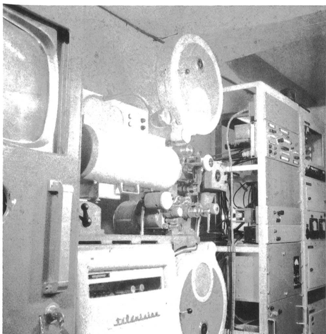
Fig. 3 Télécinéma à spot mobile utilisé au studio de Bellerive (1953/54) – Leuchtpunkt (Flying-Spot)-Filmabtaster im Studio Bellerive (1953/54)
