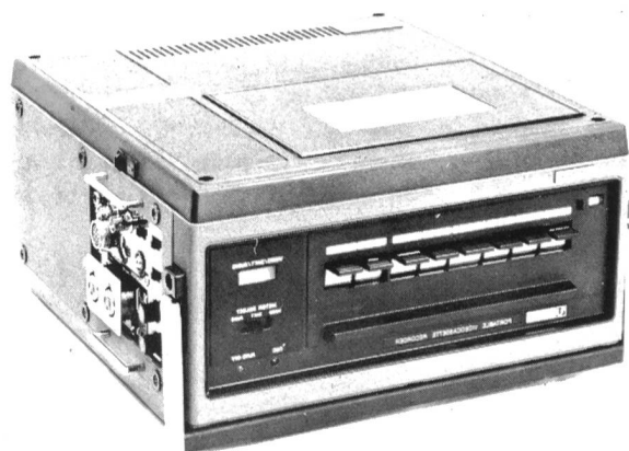
Fig. 18 Magnétoscope portable pour le journalisme électronique (ENG) — Tragbares Magnetband-Aufzeichnungsgerät für den elektronischen Journalismus (ENG)
