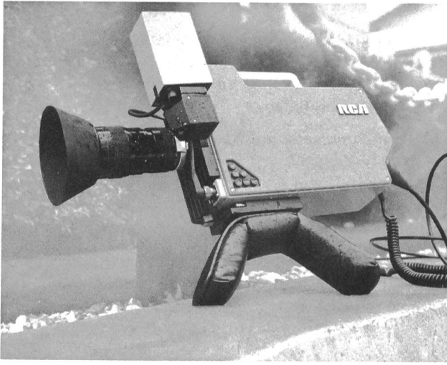
Fig. 17 Caméra portable pour le journalisme électronique (ENG) — Tragbare Farbfernsehkamera für den elektronischen Journalismus (ENG)
