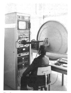
Fig. 3 Anlage für die Einspeisung von Fernsehprogrammen mit mobilem Richtstrahl-Link auf La Dôle
