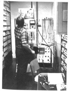
Fig. 2 Messungen an einer Telefonie-Richtstrahlbucht
