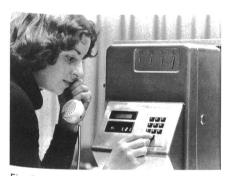
Fig. 3 Nouvel appareil téléphonique à prépaiement avec clavier de sélection
