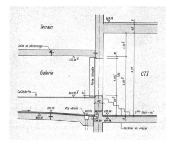
Fig. 6 Coupe de la galerie à l'entrée dans le central
