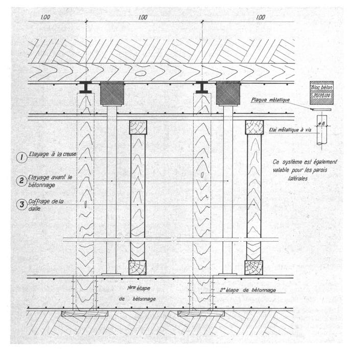
Fig. 5 Plan d'étayage du tunnel
