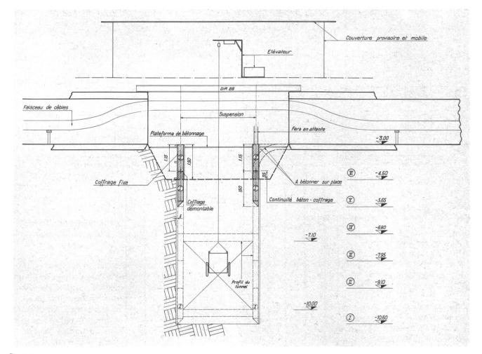
Fig. 4 Schéma de creusage du puits
