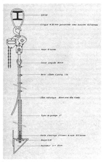
Fig. 3 Schéma du dispositif de suspension
