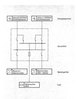
Fig. 2 Gleichstromspeiseblock 48 V/1000 A
