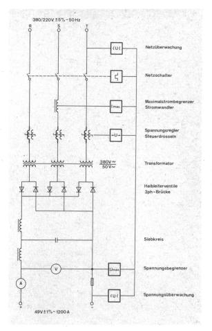
Fig. 10 Prinzipschema Gleichrichter 48 V/1200 A
