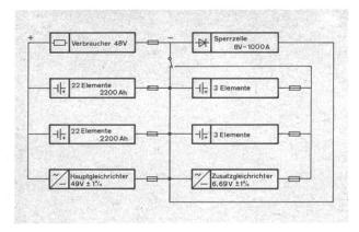
Fig. 12 Blockschema Gleichstromversorgung
