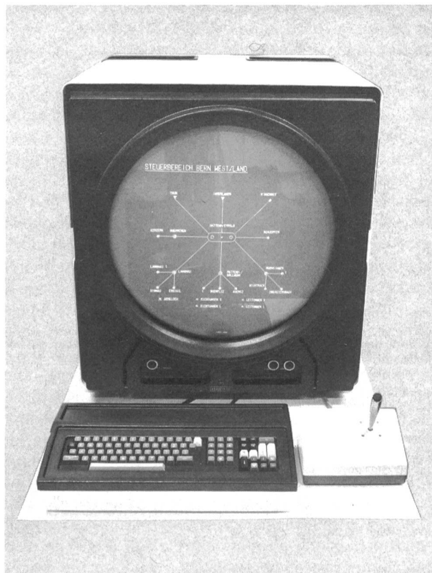
Fig. 14 Grafischer Display mit Eingabegeräten und Bild Steuerbereich (Beispiel) — Unité de visualisation graphique avec pupitre d'entrées et image du secteur de commande (exemple)
