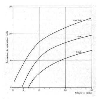
Fig. 9 Variation du découplage de polarisation en fonction de la fréquence Cas de la polarisation circulaire
