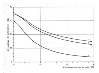
Fig. 8 Relation entre le découplage de polarisation et l'affaiblissement par la pluie
