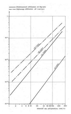
Fig. 7 Cœfficients d'affaiblissement et de déphasage différentiels en fonction de l'intensité des précipitations
