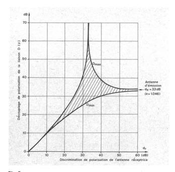
Fīg. 5 Découplage de polarisation d'une liaison en polarisation circulaire
