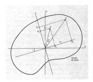
Fig. 6 Dépolarisation causée par un affaiblissement anisotrope  $(A_1 > A_2)$  lors du passage à travers une goutte de pluie
