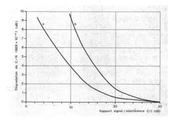
Fig. 11 Interférence dans le même canal (modulation 4 CPSK avec encodage différentiel)
