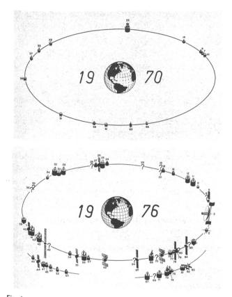
Fig. 1 Degré d'occupation de l'orbite géostationnaire (d'après Comsat Techn. Review, Spring 1976)
