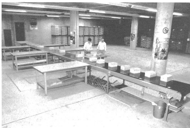
Fig. 7 Förderbandanlage für die Telefonbuchspedition
