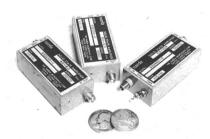
Rauscharme FET-Mikrowellen-Verstärker von 2...18 GHz. Rauschfaktor von 2.2 bis max. 10 dB. Gain von 10 bis max. 58 dB.
