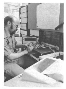
Fig. 1 Vollautomatische, in den Produktionsablauf integrierte Prüfung von bestückten Leiterplatten
