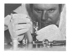
Fig. 3 Aufbau der Elektronenkanone in einer Satelliten-Wanderfeldröhre bei extrem staubfreien und klimatisierten Verhältnissen
