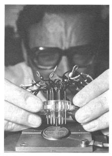
Fig. 2 Vorbereitung eines steuerstrom-abschaltbaren Leistungsthyristors für den Labortestbetrieb
