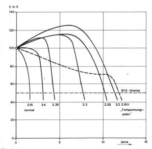
Fig. 1 Andamento della capacità per diverse tensioni Tiefspannungszellen — Elementi a bassa tensione Jahre — Anni 50-%-Grenze — Limite 50 %
