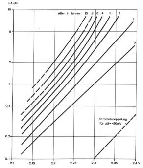
Fig. 4 Correnti in funzione della tensione per diversi gruppi di età Alter in Jahren — Età in anni Stromverdoppelung für  $\Delta$  U = +50 mV — Raddoppio della corrente per  $\Delta$  U = +50 mV
