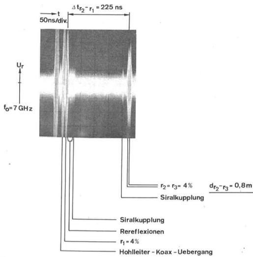
Fig. 15 Reflexionsverlauf des Testhohlleiters; Bestimmung der Leitungslänge
