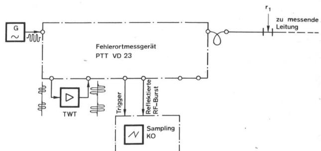
Fig. 18 Messschaltung mit Videodetektion und HF-Oszilloskop
