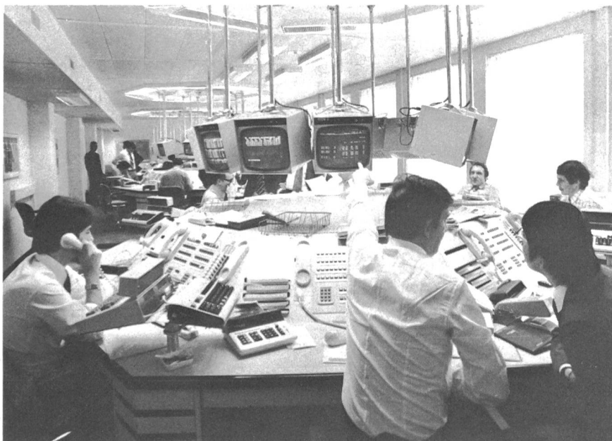
Fig. 2 Devisenhändleranlage mit Bildschirmen und den speziellen Händler-Telefonapparaten
