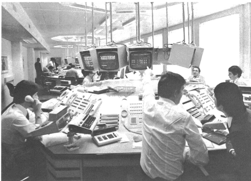
Fig. 2 Devisenhändleranlage mit Bildschirmen und den speziellen Händler-Telefonapparaten
