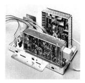
Fig. 7 Steckbares Zusatzchassis mit Empfangsteil, hochintegriertem Signal-Zwischenspeicher und Steuerelektronik für das einblendbare Vollbild im Bild (Foto Grundig)
