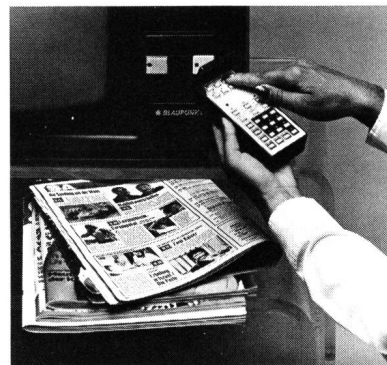
Fig. 11 Fernbedienung und Empfänger für den mikroprozessorgesteuerten Programmablauf. 19 Speicherplätze lassen sich über den Fernbedienungsgeber direkt anwählen und ebenso viele Programmwünsche speichern. Die für die vielfältigen Programmierfunktionen benötigten Tasten (oben auf der Fernbedienung) werden nach Gebrauch von einer Klappe abgedeckt (Foto Blaupunkt)
