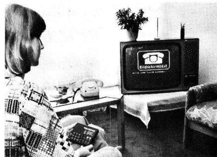
Fig. 16 Bildschirmtext im Zweiwegverfahren der Deutschen Bundespost, vorne das einfache Bediengerät (drahtlos) für die Kommunikation mit dem Computer (Foto DBP)
