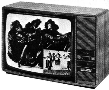
Fig. 5 Teilbild im Bild (Foto Telefunken)
