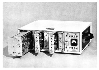
Fig. 2 In der Senderkontrolleinheit wird das Videosignal einer 70-MHz-Zwischenfrequenz aufmoduliert. Ebenso erfolgt die Modulation von bis zu drei Tonkanälen auf entsprechende Hilfsträger. Das Gerät ist in verschiedene Subeinheiten aufgeteilt, die sich leicht auswechseln lassen
