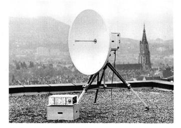
Richtstrahlanlage Farinon FV12P, betriebsbereit mit horizontal polarisierter 1,2-m-Parabolantenne. Zwischen der Kontrolleinheit und dem HF-Kopf können bis zu 150 m Verbindungskabel eingesetzt werden
