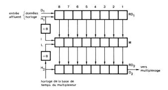
Fig. 3 Principe de la conversion d'horloge dans l'interface
