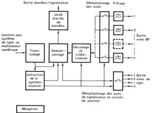
rig. 1 Schéma simplifié d'un multiplexeur MIC
