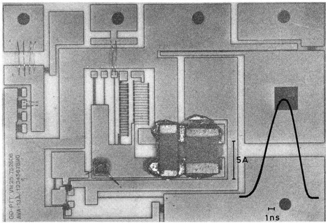
Makroaufnahme eines Avalanche-Transistor-Laserreibers mit Stromimpuls
