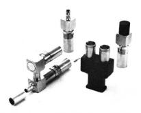
HF-Verbinder PTT BW 72. SUHNER HF-Koaxialverbinder QLB erfüllen die PTT Vorschriften der BW 72. Sie zeichnen sich aus durch hohe Kontaktsicherheit und sind störstrahlungsdicht. Die SUHNER Voll-CrimpTechnik eliminiert alle Lötstellen, reduziert die Montagezeit und erhöht die Zuverlässigkeit. Alle Verbinder können mit demselben Werkzeug montiert werden.
