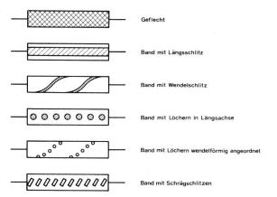
Fig. 5 Untersuchte Kabeltypen
