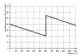
Fig. 11 Verlauf des Empfangssignals längs eines Kabels mit Zwischenverstärker
