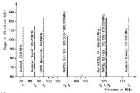
Fig. 14 Frequenzen und Pegel des Versuchssystems
