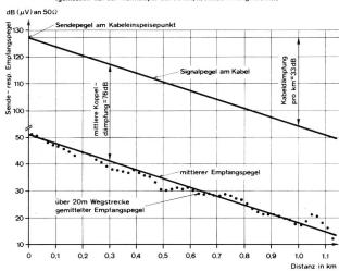
Fig. 9 Empfangspegel bei 80 und 160 MHz
