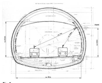
Querschnitt durch die Tunnelröhre
