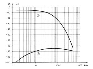
Fig. 6 Kabel- und Koppeldämpfung in Funktion der Frequenz (Kabeltyp S 17873-2)
