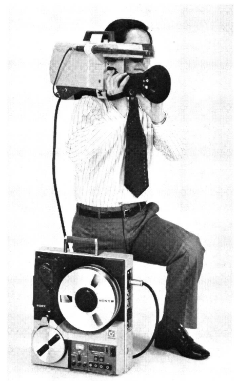
Fig. 5 Farbfernsehkamera BVP200P und Video-Spulen-Recorder mit 1-Zoll-Band BVH500PS von Sony
