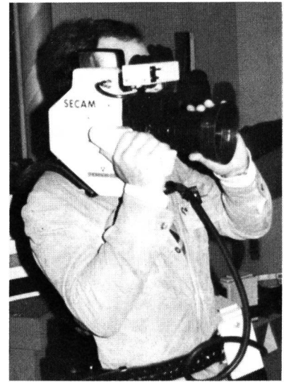
Fig. 4 Die kompakteste Farbfernsehkamera der Ausstellung in Montreux war die Microcam von Thomson-CSF
