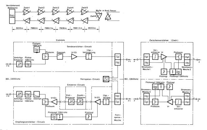
Fig. 1 Verlauf der Erprobungsstrecke mit Blockschaltbildern einer V300-Endstelle und eines pilotgeregelten Zwischenverstärkers
