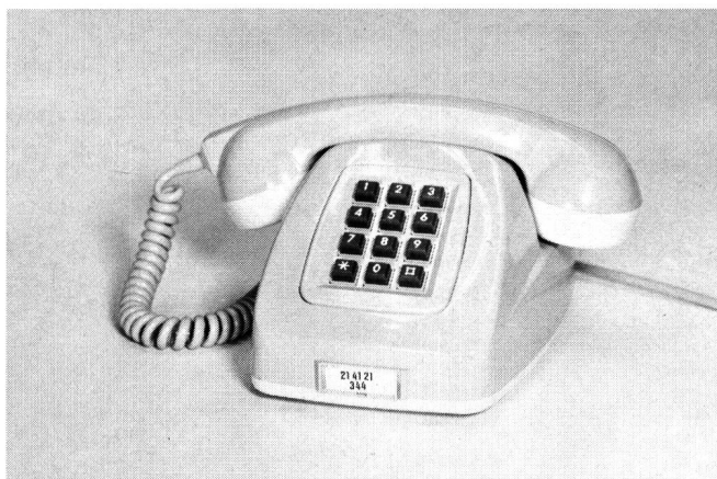
Fig. 1 Telefonapparat TS 70 RG mit Rufnummerngeber für 20 Teilnehmernummern – Appareil téléphonique avec composeur automatique pour 20 numéros d'abonnés TS 70 RG
