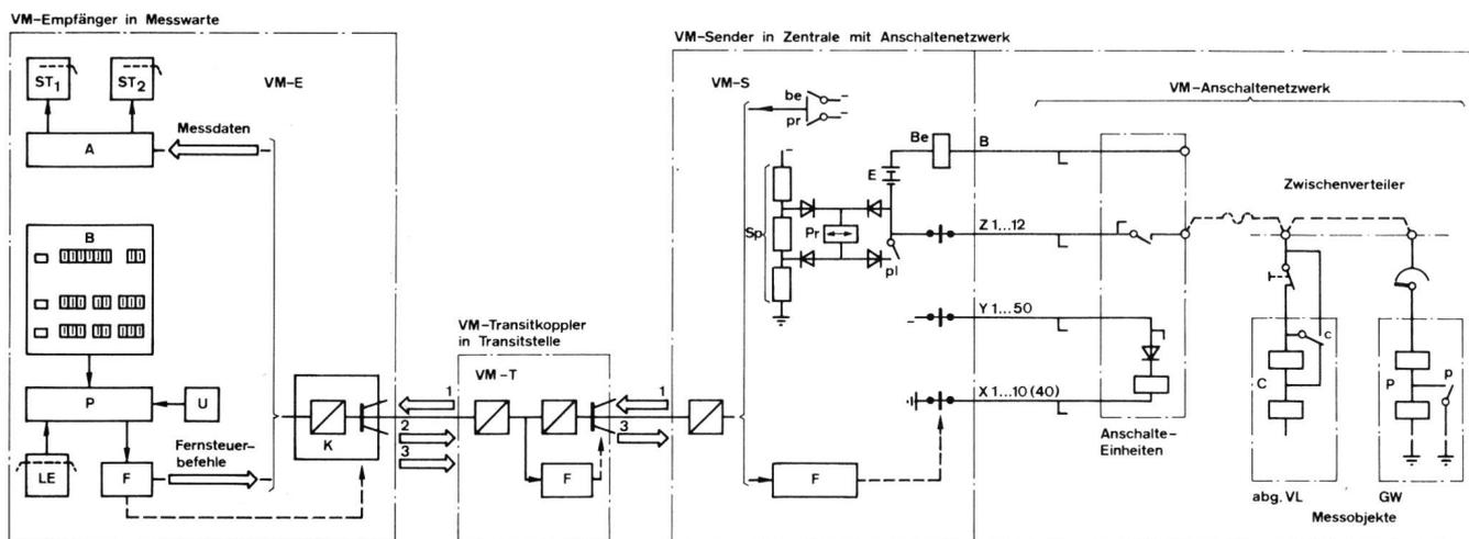
**Fig. 6** Schaltungstechnische Übersicht über den ferngesteuerten Betrieb der Verkehrsmesseinrichtungen PTT – Schéma synoptique de l'exploitation télécommandée des installations de mesure du trafic PTT
