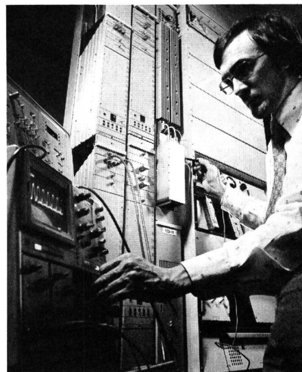
Fig. 2 Messungen an der Endausrüstung des 140-Mbit/s-Übertragungssystems in der Zentrale. Diese Einheit stellt das Bindeglied zwischen herkömmlicher PCM-Technik und der optischen Übertragungsstrecke dar
