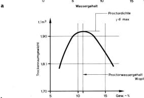
Fig. 1a Druckfestigkeit und Proctor-Dichte eines Bodens
