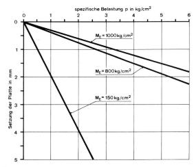
Fig. 2 Elastizitätsmodulkurve
