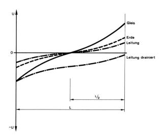
Fig. 3 Potentialverhältnisse einer Leitung im Einflussbereich einer Gleichstrombahn
