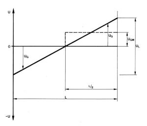
Fig. 1 Spannungsverhältnisse am Gleis
