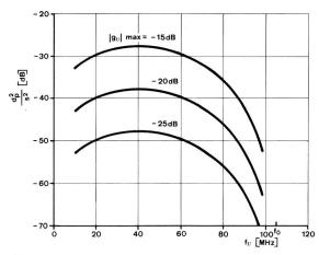
Fig. 12 Perturbations dues aux irrégularités périodiques dans le cas d'une pointe de la fonction de réflexion de valeur maximale  $\left|g_{v}\right|_{max}$  à la fréquence  $f_{v}$
