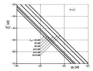
Fig. 7 Perturbations dues aux irrégularités aléatoires dans le cas du code 4B-3T et impulsions en  $\sin^2$  en fonction de l'atténuation de la section de régénération  $\textbf{A}_{\text{c}}$
