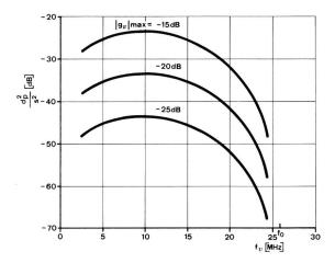
Fig. 9 Perturbations dues aux irrégularités périodiques dans le cas d'une pointe de la fonction de réflexion de valeur maximale  $\left|\left.g_{v}\right|\right|_{max}$  à la fréquence  $f_{v}$
