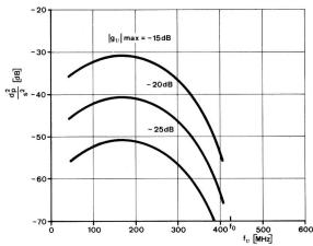
Fig. 13 Perturbations dues aux irrégularités périodiques dans le cas d'une pointe de la fonction de réflexion de valeur maximale  $|g_v|_{max}$  à la fréquence  $f_v$
