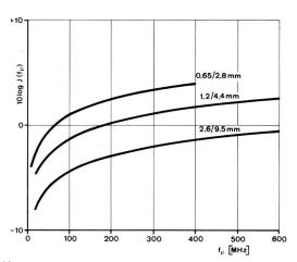
Fig. 21 Fonction J (f<sub>v</sub>) pour les différents types de câble
