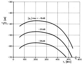
Fig. 16 Perturbations dues aux irrégularités périodiques dans le cas d'une pointe de la fonction de réflexion de valeur maximale  $\left|g_{v}\right|_{max}$  à la fréquence  $f_{v}$
