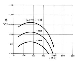
Fig. 15 Perturbations dues aux irrégularités périodiques dans le cas d'une pointe de la fonction de réflexion de valeur maximale  $\|g_v\|_{max}$  à la fréquence  $f_v$
