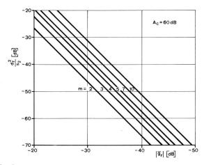
Fig. 6 Perturbations dues aux irrégularités aléatoires dans le cas d'une section de régénération de  $A_{\rm c}=60~{\rm dB}$  en fonction du nombre m de niveaux du code (impulsions en sin²)
