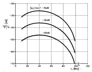
Fig. 10 Perturbations dues aux irrégularités périodiques dans le cas d'une pointe de la fonction de réflexion de valeur maximale  $\left| \mathbf{g}_{v} \right|_{\text{max}}$  à la fréquence  $\mathbf{f}_{v}$
