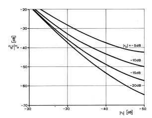
Fig. 17 Perturbations dues aux irrégularités d'impédance des épissures  $(r_i)$  et des terminaisons  $(r_o)$
