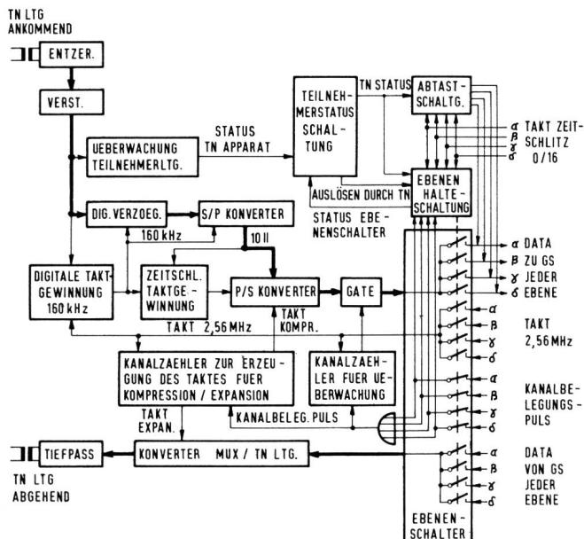
**Fig. 15** Blockschema der Teilnehmerschaltung – Schéma-bloc du circuit d'abonné
