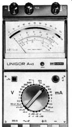
62 Messbereiche für V, A,  $\Omega$ , nF- $_{\mu}$ F, dB
