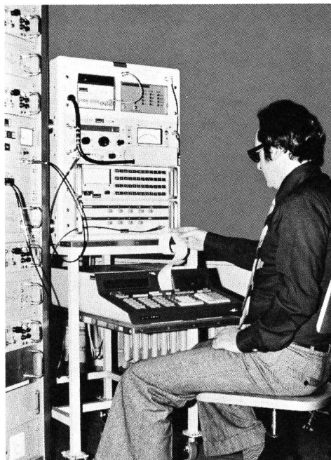
Fig. 2 Rechnergesteuerter Messplatz für Qualitätsmessungen
