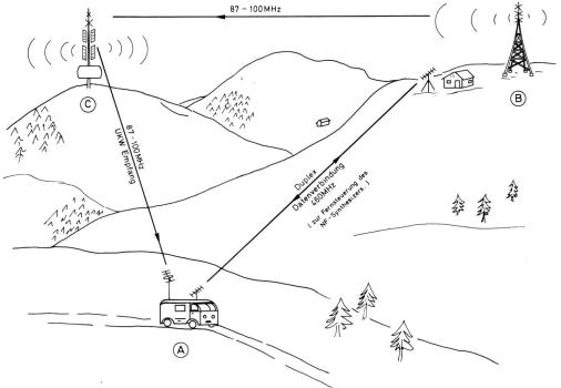
Fig. 5 Prinzip der Fernmessung
