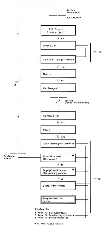
Fig. 6 Blockschema der Fernmessung
