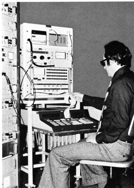
Fig. 2 Rechnergesteuerter Messplatz für Qualitätsmessungen
