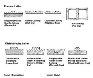
Fig. 2 Querschnitte verschiedener Wellenleiter für die Millimeter-Wellentechnik
