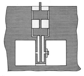
Fig. 10 Empfangsmischer für den 80-GHz-Bereich
