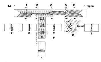
Fig. 3 35-GHz-Gegentaktmischer, Layout der planaren Struktur
