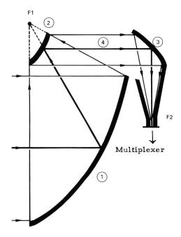
Fig. 8 Strahlengang in der Multibandantenne
