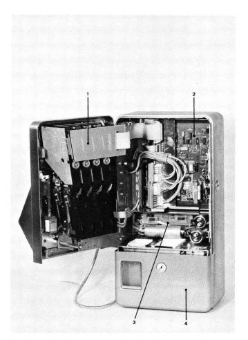
Fig. 5 Innenansicht der Kassierstation – Vue intérieure du poste à prépaiement
