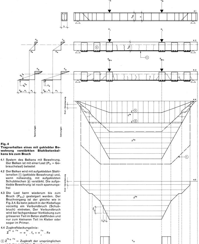
$\bigcirc$  Z<sup>fe+ Fe</sup> = Zugkraft der ursprünglichen und der geklebten Bewehrung zusam-
