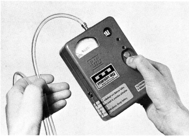
Fig. 4 Das Explosimeter Gasotrans im Einsatz. Normalerweise ist das Gerät hierzu in der Ledertasche zu lassen. Es ist darauf zu achten, dass die Luft-Auslassbohrung auf der Rückseite des Gehäuses beim Halten des Gerätes frei bleibt – Explosimètre Gasotrans prêt à l'emploi. D'ordinaire, il faut laisser l'appareil dans sa sacoche de cuir. Il faut veiller à ne pas obstruer avec la main l'orifice d'évacuation d'air situé sur la face arrière
