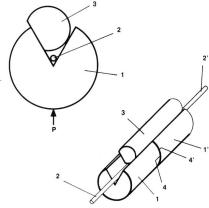
Fig. 1 Prinzip Faser-Faser-Kupplung. Erläuterungen im Text
