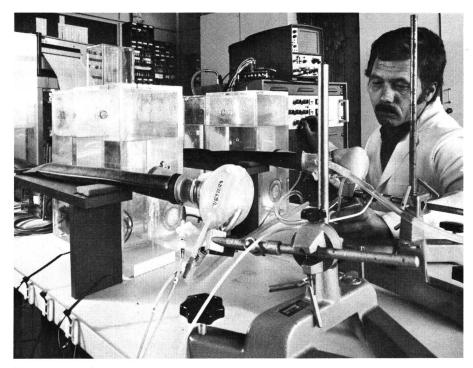
Fig. 5 Elektropneumatischer Antrieb von künstlichen Herzen im Laboratoriumstest. Die beiden Blutpumpen (Bildmitte) ersetzen im Laboratorium – wie auch im Tierversuch – die linke beziehungsweise die rechte Herzkammer
