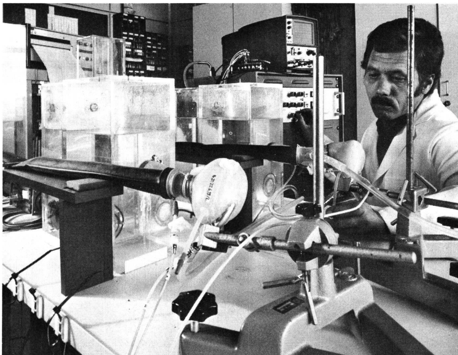
Fig. 5 Elektropneumatischer Antrieb von künstlichen Herzen im Laboriumstest. Die beiden Blutpumpen (Bildmitte) ersetzen im Laborium – wie auch im Tierversuch – die linke beziehungsweise die rechte Herzkammer
