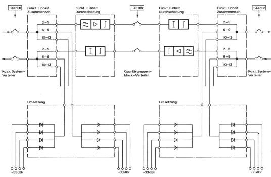
Fig. 9 Blockschaltbild für die Durchschaltung in der Leitungsfrequenzlage in einem 60-MHz-System. Das Beispiel zeigt die Weiterschaltung der Hauptgruppen beziehungsweise Quartärgruppen 2...5
