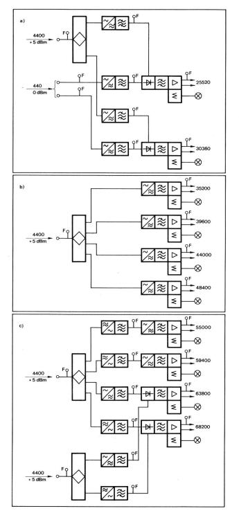
Fig. 3 Blockschaltbild der Ausrüstung für die Trägerfrequenzerzeugung, die in den Funktionseinheiten für die Quartärgruppenumsetzung untergebracht ist, für
