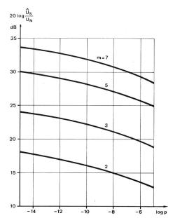
Fig. 4 Störabstand 20 log ( $\hat{\mathbf{U}}_{s}/\mathbf{U}_{N}$ ) in Funktion der Fehlerrate p mit der Signalstufenzahl m als Parameter
