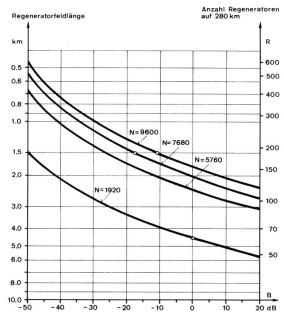
Fig. 5 Regeneratorfähigkeitsfaktor B (Voraussetzungen  $p_{280}=10^{-8}, m=3,4B3T\text{-Code}\ m=3)$
