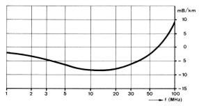
Fig. 1 Abweichung der Betriebsdämpfung vom √ f -Verlauf
