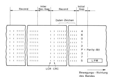
Fig. 2 Schematische Darstellung der Anordnung der Daten auf dem Magnetband einer 9-Spur-Computerbandstation
