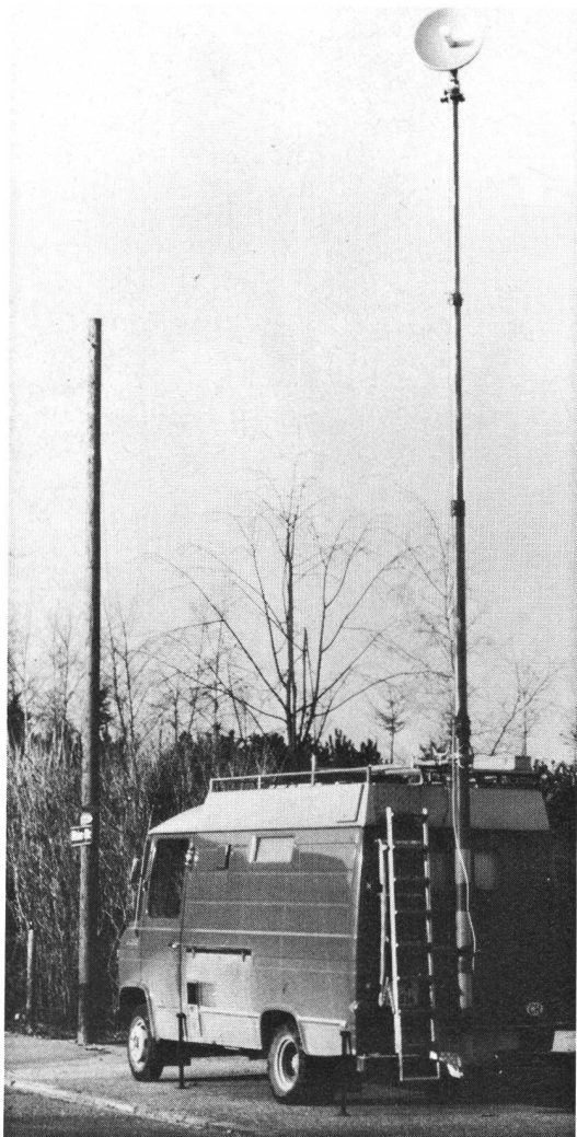
Fig. 7 Voiture de mesure équipée du convertisseur SHF-UHF
