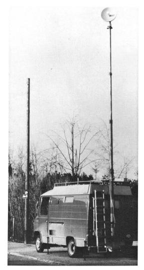
Fig. 7 Voiture de mesure équipée du convertisseur SHF-UHF
