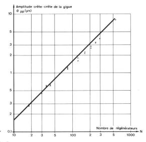
Fig. 5 Accumulation de la valeur crête-crête de la gigue lors de l'émission de séquences alternées
