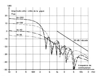
Fig. 6 Valeur crête-crête de la gigue en fonction de la fréquence de commutation entre deux motifs
