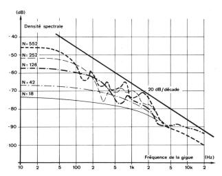
Fig. 4 Densité spectrale de la gigue en fonction du nombre de régénérateurs Référence  $0\ dB=1\ (IT)^2\cdot HZ^{-1}$
