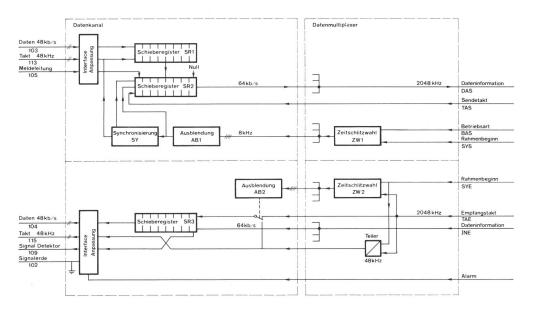
Fig. 2 Blockschema für die Datenanpasseinheit 48 kbit/s
