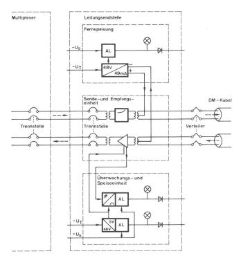
Fig. 3 Blockschaltbild einer Leitungsendstelle
