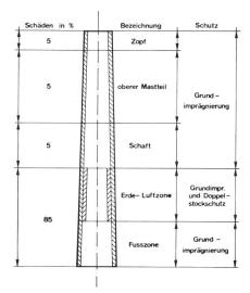
Fig. 10 Coupe longitudinale d'un poteau à double protection (double imprégnation) - Sezione longitudinale di un palo con doppia protezione del piede
